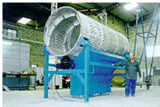
Figura 8 – Tubos vazados em aço inox para retirada de contaminações grosseiras para linha de revalorização de plástico.
